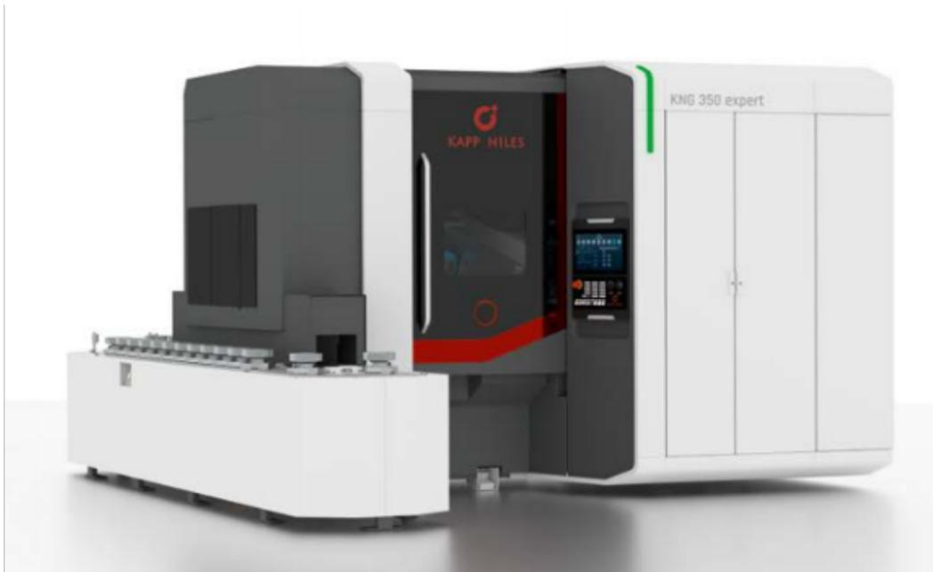
蜗杆磨齿机磨削裂纹原因：表面渗碳淬火组织中的残余奥氏体在磨削过程中，由于强研磨热的影响和冷却剂的冷却，转变为新的马氏体，使得零件表面局部体积膨胀，零件表面拉伸应力增加，导致应力集中，继续磨削，容易加速磨削裂纹的产生。另外，新生马氏体脆性大，磨削也容易加速磨削裂纹的发生。这种蜗杆螺旋表面在磨削时砂轮与零件的接触面积大，一方面磨削热量大，冷却剂不易进入磨削区域有效冷却磨削面，因此蜗杆螺旋表面因磨削产生的热量足以使磨削表面的薄层再次奥氏体化。然后再淬火，变成淬火麻体。表面层中残留的奥氏体也在急热淬火的作用下转变为马氏体，给表面层造成额外的组织应力，加上研磨形成的热量，可以非常快速地提高零件表面的薄层温度。这种组织应力和热应力的重叠会导致磨削表面出现磨削裂纹。常州高效磨齿机销售中心蜗杆磨齿机是利用砂轮作为磨具加工圆柱齿轮或某些齿轮(斜齿轮，锥齿轮等)加工刀具齿面的齿轮加工机床。
